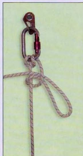
Si se va a dejar el nudo de fuga durante algún tiempo, como en el caso de las tirolinas, convendrá asegurarlo con un nudo adicional y un mosquetón, que se podrá fijar a un anclaje, por ejemplo, para evitar que una tracción accidental del nudo de fuga pudiera hacer correr la cuerda inesperadamente.
