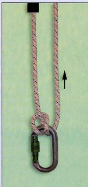
La adición de un mosquetón al nudo dinámico nos permitirá convertirlo en autoblocante, es decir, que la cuerda pueda pasar por el sistema solamente en un sentido, quedando retenida y no deslizando en sentido contrario. El sistema es reversible, de manera que si se retira el mosquetón adicional, vuelve a funcionar en ambos sentidos.
